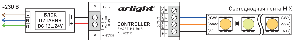
Рис. 2. Подключение светодиодной ленты MIX (CCT).
